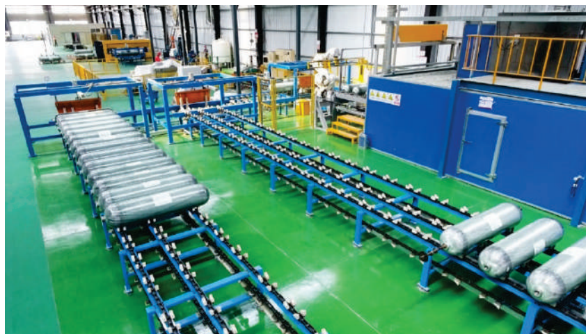
氢能储气瓶产线
