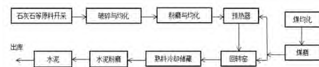
水泥生产的主要工艺流程图
